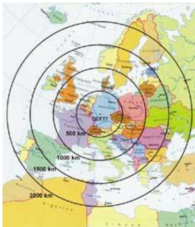
Abbildung: geografische Reichweite des DCF77-Signals (Quelle: Physikalisch Technische Bundesanstalt Braunschweig, PTB)
