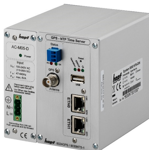
Frontansicht Basissystem 8030NTS/GPS
