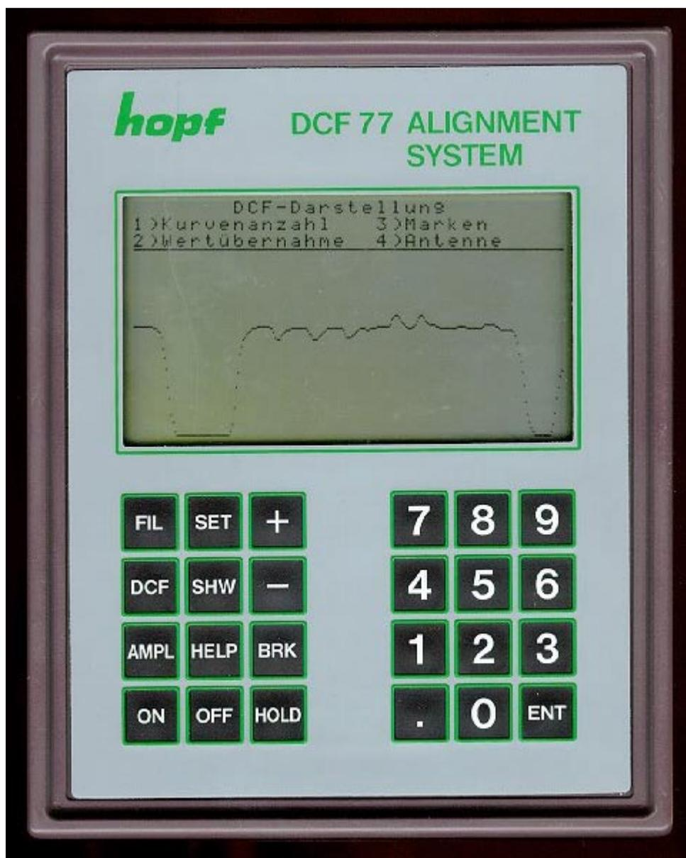
Bild 1 (DCF77 Signal Analysegerät)
